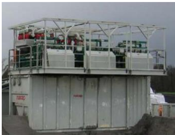
Figura 3.25: Esempio di Unità di Riciclo Fanghi
