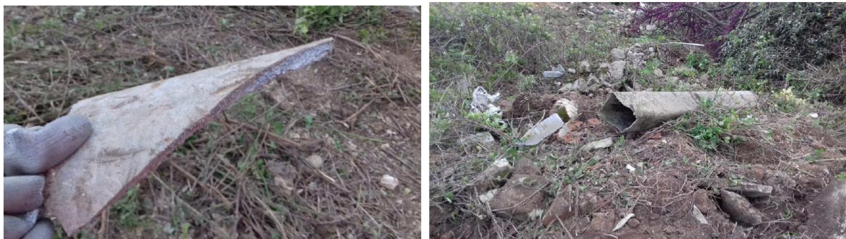
Figura 4.34: frammenti (a sinistra) e manufatti (a destra) potenzialmente contenenti amianto nell'area del Rilevato
