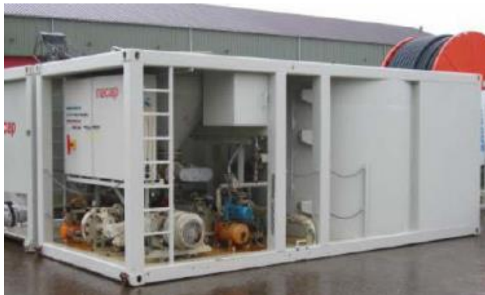
Figura 3.23: Esempio di Unità di Miscelazione Fanghi
